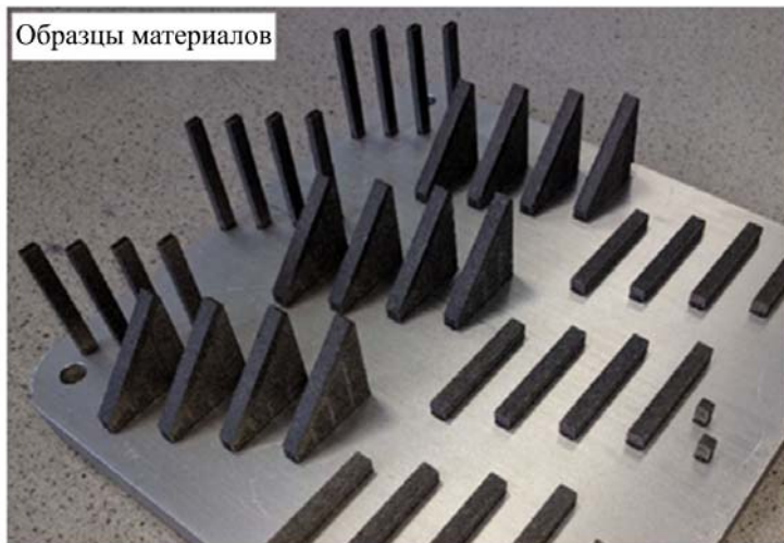
Рис. 2. Образцы материалов, изготовленные с различной ориентацией сборки из AlSi10Mg (Ноттингемский университет) [10]
