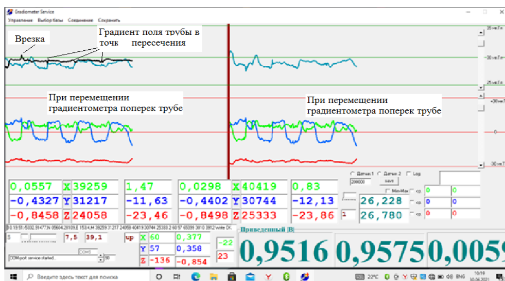
Рис. 5. Регистрация дефектов трубы при проведении измерений
