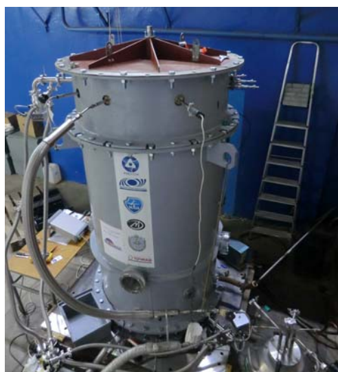
Рис. 3. КНЭ с магнитным ВТСП подвесом с запасаемой энергией свыше 5 МДж во время стендовых испытаний
